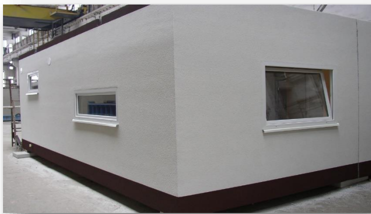
Rysunek 12 Możliwe jest również wykonanie modułów na gotowo w hali produkcyjnej.
